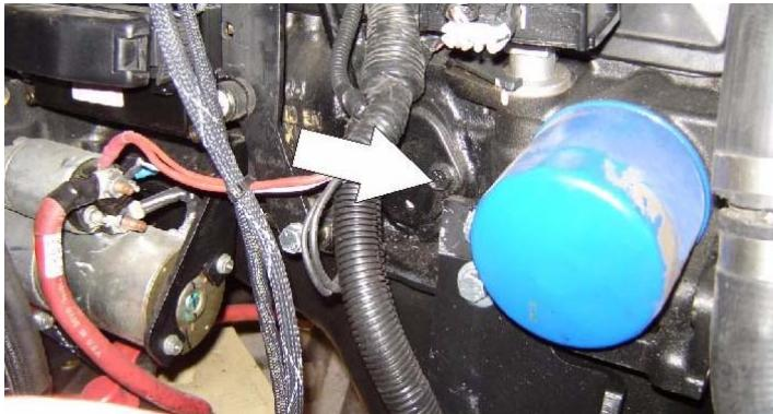
Punto(s) de lubricación - Tapa de llenado/elemento atornillable (Nº de pieza JLG 7027965)
