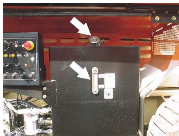
Puntos de lubricación - Tapa de llenado/nivel
