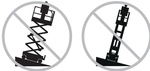
No confíe en la alarma de inclinación como indicador de nivelación. La alarma de inclinación instalada en el chasis y en la plataforma suena cuando la máquina se encuentra en pendiente muy pronunciada.
