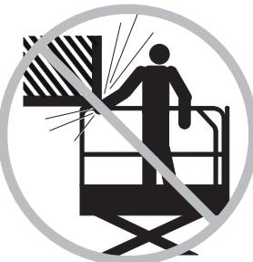
No utilice la máquina si se encuentra en el camino de una grúa o máquina elevada en movimiento, a menos que los controles de la grúa estén bloqueados o se hayan tomado precauciones para evitar cualquier posibilidad de colisión.
