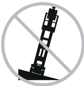
Modelos con estabilizadores: si la máquina no se encuentra en una superficie firme, no baje los estabilizadores. Evite las pendientes, los agujeros, las superficies inestables o resbaladizas y cualquier otro tipo de condiciones peligrosas.
